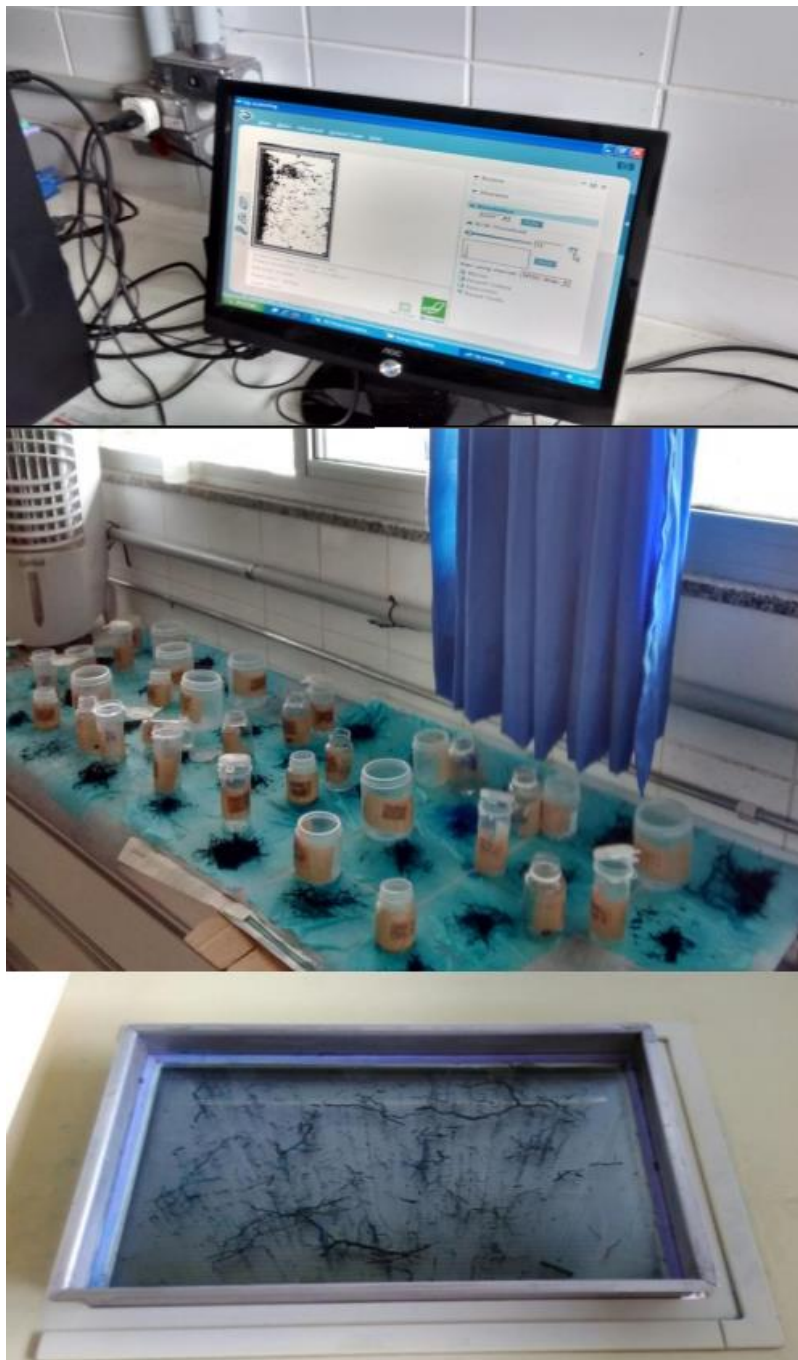
Figura 12. Procedimento de análise radicular no aparelho DELTA T SCAN®. Captura das imagens pelo programa; Preparação das amostras; Scanner de raízes.
